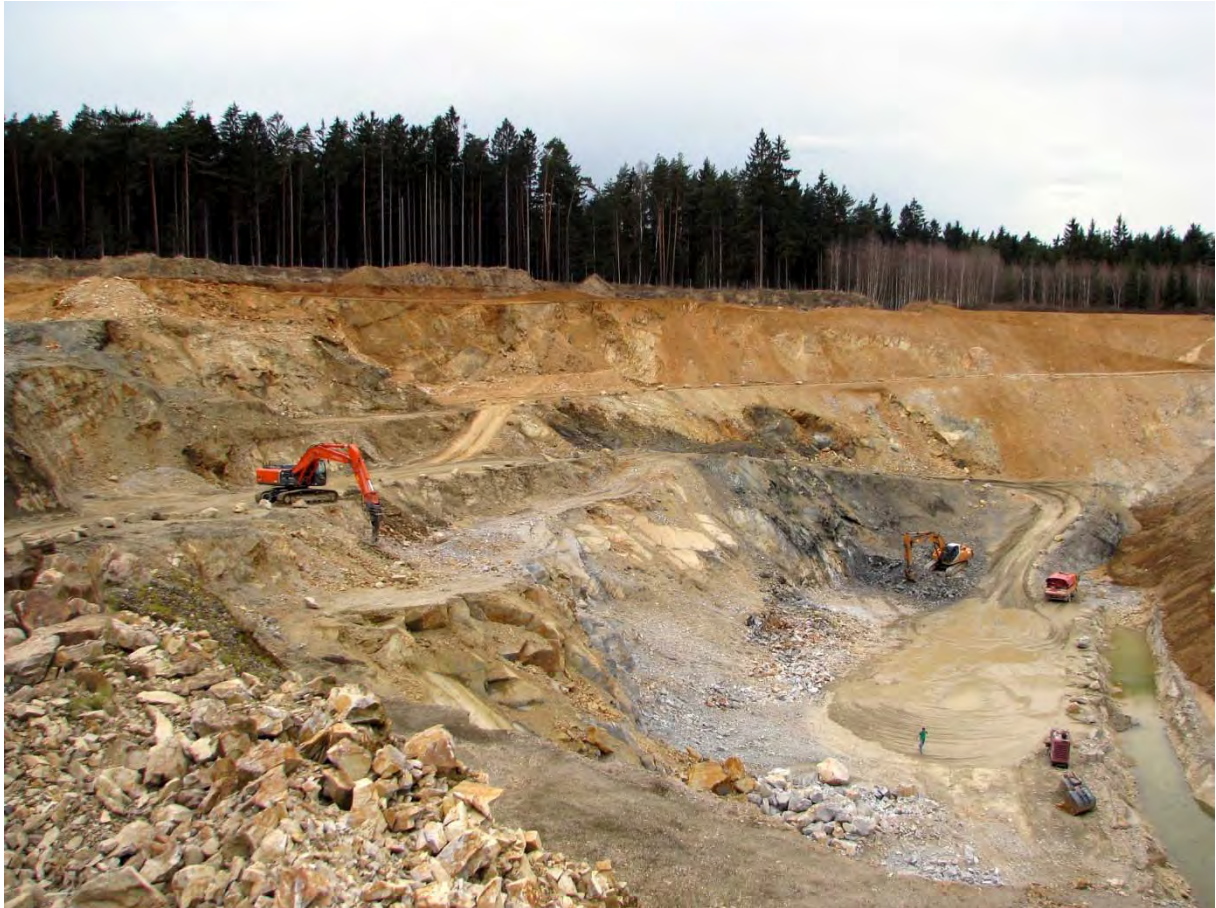
Abb. 1: Granulit-Steinbruch der Firma Marchart nördlich von Karlstetten. Rechts der Bildmitte ist eine dunkle Linie aus serpentinisierten Peridotit zu erkennen (Datum der Aufnahme, 11.04.2013).
