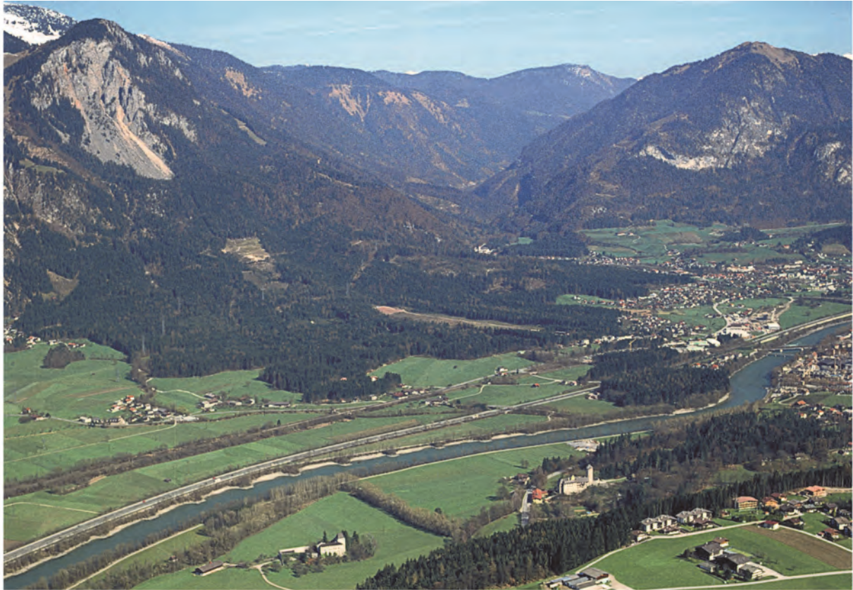
Abb. 1: Der Bergsturzbereich vom Pletzachkogel mit der römertimeitlichen Abbruchnische (links oben), dem Ablagerungsgebiet auf der Innalsole (größtenteils bewaldet) und dem Stauraum (linke untere Bildhälfte) mit den Burgen Lichtwert und Matzen. (1.4.2001)
