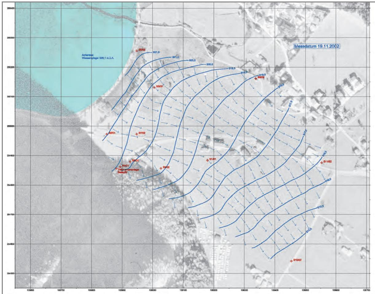
Abb. 6: Grundwasser-Gleichenplan des Messtages 19. 11. 2002.
