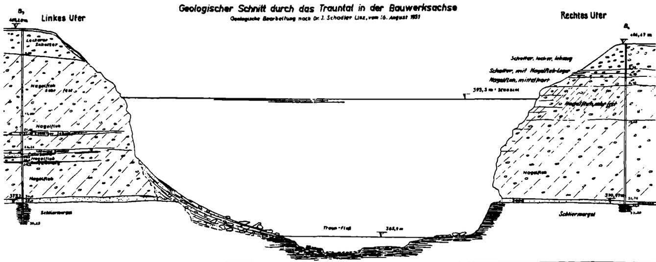
Schichtung standfest, schwer sprengbar, z. T. Trennfugendurchlässig mit Kluftwasserführung, Bodenpressung berechnet bis 4,7 kg/cm<sup>2</sup> ohne Setzung, max. 16 kg/cm<sup>2</sup>, innerer Reibungswinkel 35°; schichtparallel: leicht spaltbar, Abgleiten an Scherflächen, wesentlich ungünstigere Bodenkennwerte (E. HEHENWARTER, 1972; 1973).
