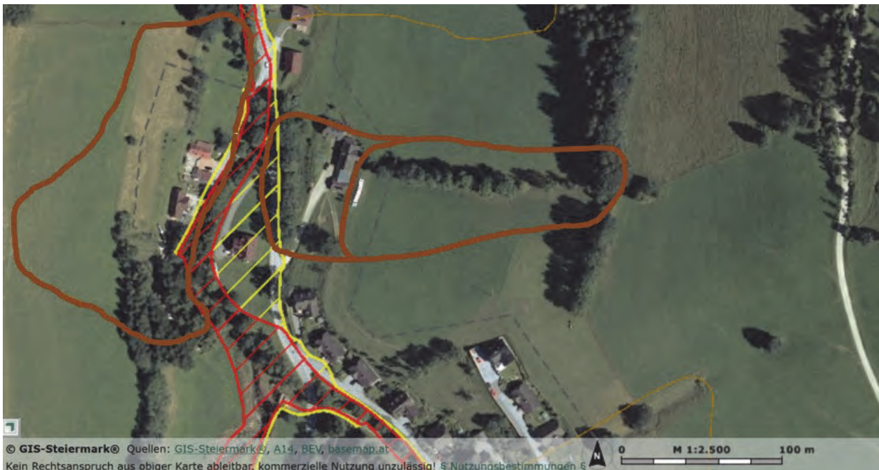
Abb. 14: In den Arealen der Erläuterungsbereiche 3a und 3b wurden braune Hinweisbereiche in den Gefahrenzonenplan der Wildbach- und Lawinenverbauung integriert, um auf mögliche Gefährdungen durch Rutschungen/Hangmuren hinzuweisen. Details sind somit über spezielle Gutachten durch befugte Personen abzuklären. Abbildungsquelle: http://www.gis.steiermark.at/
