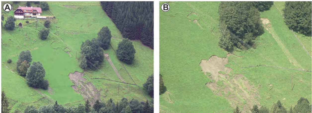
Abb. 17: Übersicht (A) und Detailaufnahme (B) des Erläuterungsbereiches 4 mit mehreren, im August 2005 entstandenen gravitativen Massenbewegungen im Lockergestein. Deutlich zu erkennen ist, dass die Prozesse bereits in diesem recht kleinen Hangbereich sehr unterschiedliche Entwicklungsstadien haben (Anriss, initiale Rutschung bis Hangmure). Eine Quantifizierung der Einflüsse verschiedener Ursachen, prozessauslösender und den Prozessablauf bestimmender Faktoren auf das raum-zeitlich variable Prozessgeschehen ist für im Zuge von Niederschlagsereignissen spontan erfolgenden gravitativen Massenbewegungen kaum/nicht möglich. Deshalb sind auch Aussagen im Kontext zur Gefahr und zum Klimawandel nur im Sinne von worst case -Betrachtungen möglich. Fotoquellen: A: Gemeinde Gasen; B: GBA.
