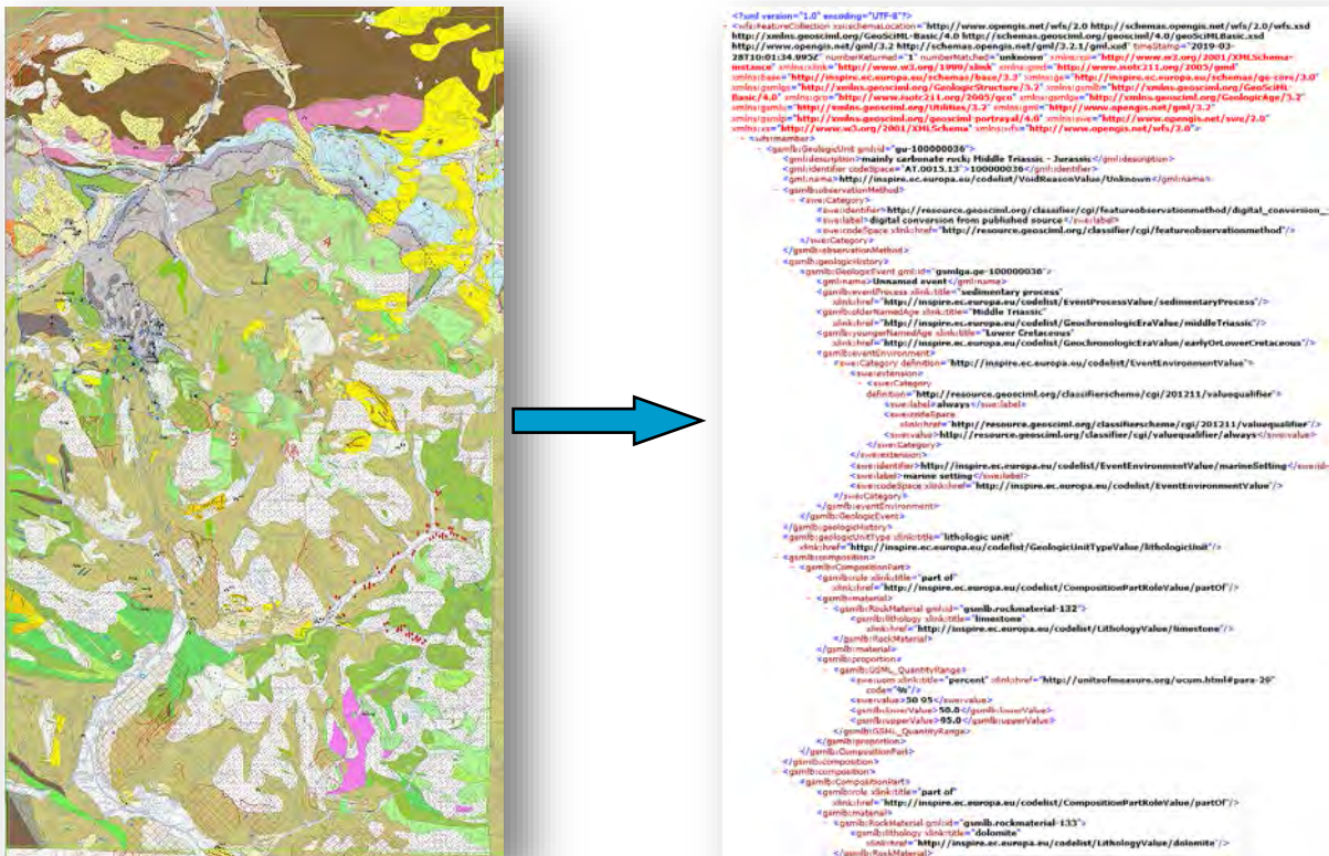
Abb. 1: Von der GIS-Darstellung einer geologischen Karte (hier Blatt Radenthein-Ost) zu maschinenlesbaren geologischen Informationen in Form eines GML-Files (Beispieldarstellung KM500).
