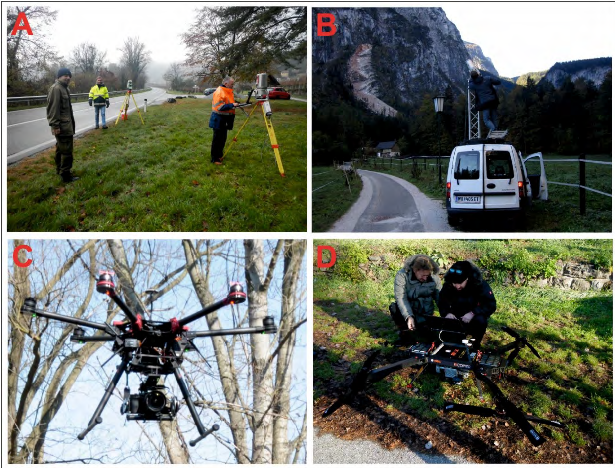
Abb. 1: Übersicht unterschiedlicher Datenerhebungsmethoden. (A) stop-and-go, TLS-Vermessung mit einem Stativ; (B) stop-and-go, TLS-Vermessung mit einem Fahrzeug (MELZNER et al., 2013; SCHILLER & MELZNER, 2017); (C) Hochauflösende photogrammetrische Vermessung unter Verwendung eines ShapeMetriX-UAV (Kamera Sony A7R, Foto: Andreas Gaich); (D) Mobile TLS-Vermessung mit einem RiCOPTER, der mit einem Laserscanner VUX-SYS AP20 ausgestattet ist (Quelle: MELZNER & SCHWARZ, 2019).
