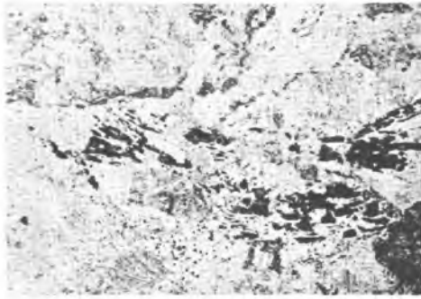
Abb. 10. Serizitführender Gangquarz mit Einschlüssen von hypidiomorphem Baryt. Die hellgraue Grundmasse besteht aus xenomorph verwachsenem Gangquarz. Die grauen Flecken mit hohem Relief sind Aggregate aus feinschuppigem Serizit. Die dunkelgrauen bis schwarzen nadelig, tafeligen Querschnitte mit hohem Relief rühren von den Einschlüssen von Baryt her. Nicols //, Vergr. ca. 55 ×
