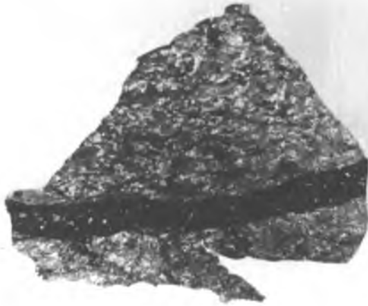
Porphyritgang in Gneis, Dünnschliff, Übersichtsaufnahme. Das braune Gesteinsglän erscheint dunkel.
