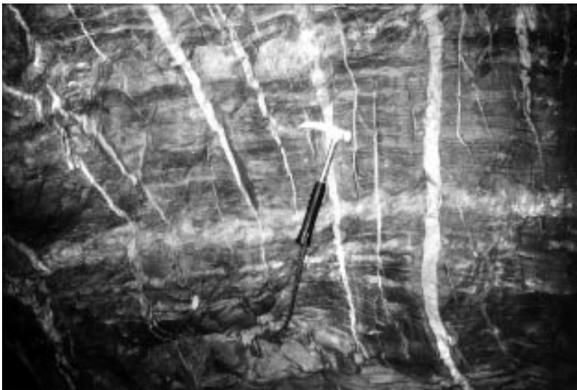
Abb. 51. Schichtdiskordante, mit Quarz und Scheelit vererzte Zerrklüfte in laminiertem, Ankerit und Pyrit führendem Chlorit-Sericit-Quarzitschiefer des Erzlagers V4.
