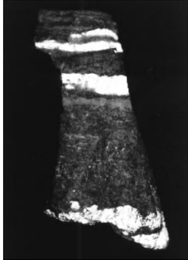
Abb. 152. Kristalliner Erzlagenbau mit Scheelit, Pyrit, Antimonit und Quarz, unter Bestrahlung mit kurzwelligem UV-Licht. Scheelit durch Lumineszenz (weiß) hervortretend. Großanschliff.
