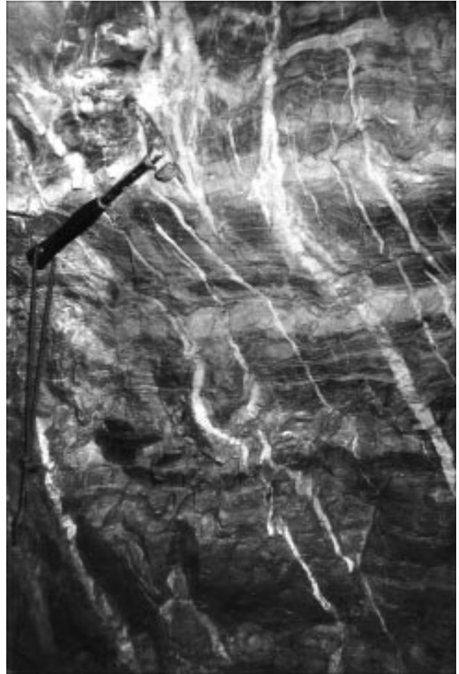
Abb. 52. Durch großenteils einschichtige affine Zergleitung in den Hauptschieferungsflächen (= Schichtung) diagonal gestellte, mit Scheelit und Quarz vererzte Zerrkluft-Gangschar in einer Abbauzeche unter dem Erzlager V4 am 9. Lauf.
