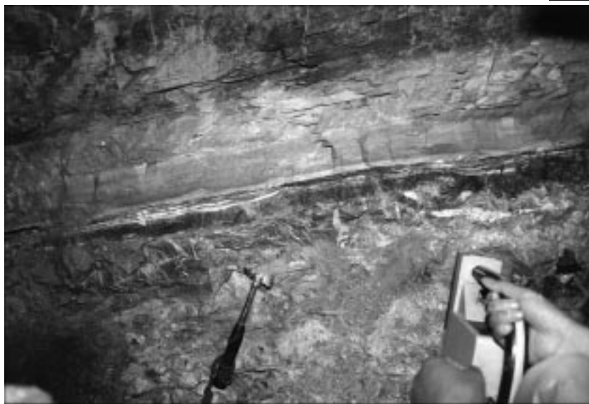
Abb. 39. ▲▲▲ Erzlager V1 (am 9. Lauf) mit kristallinem Lagenbau durch Abbildungskristallisation nach schichtiger Primäranreicherung von Antimonit, Quarzit, Pyrit und Scheelit.
