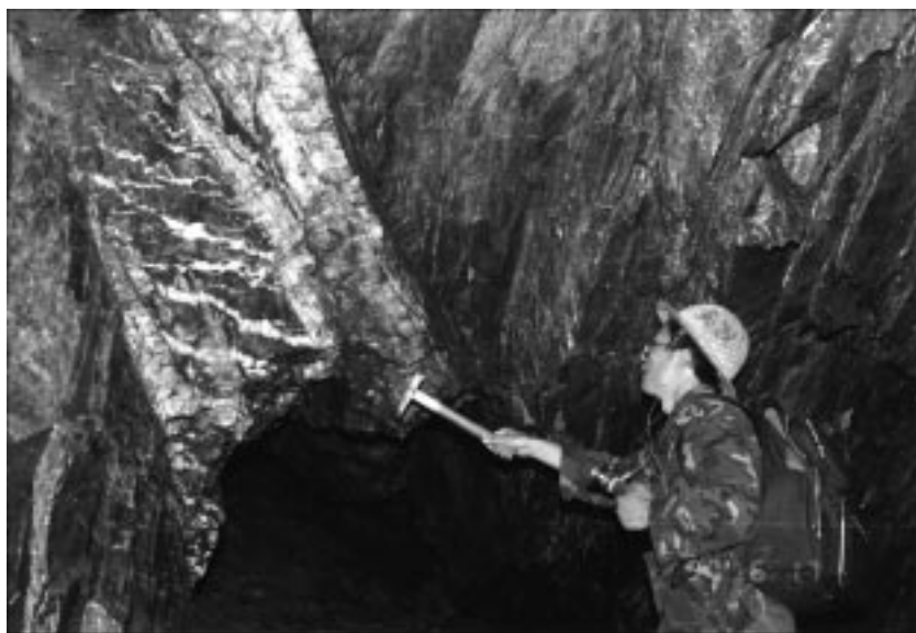
Abb. 238. Sedimentäre Schichtung des Metasedimentes. Überprägungen durch oft mehrere Transversalschieferungen sowie Scherkluffe verwirren das Aufschlussbild und führen z.T. zu Fehlinterpretationen.
