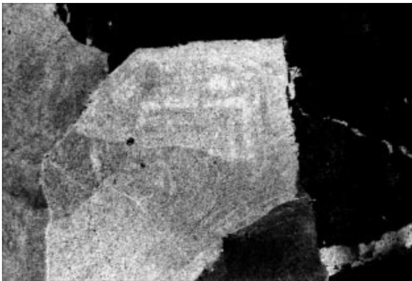
Abb. 113. Grobkörniges Scheelit-Quarz-Kristallit mit Dolomit-Kristallisation in Haarrissen (rechts unten und Mitte). Scheelit: grauschwarz, Quarz: grauweiß; Zonarbau durch Mineralpigmente und Flüssigkeitseinschlüsse. Dünnschliff, Nicols +. Natürl. Größe 3,33 × 2,22 mm.
