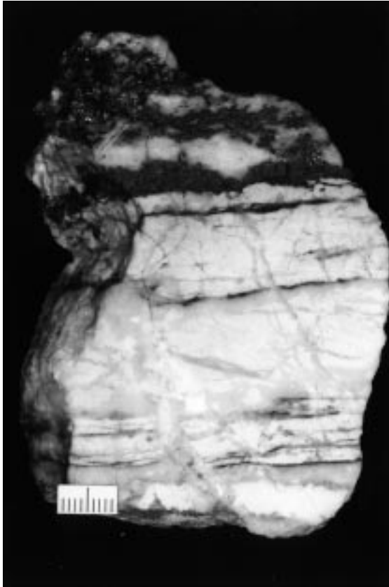
Abb. 151. Scheelit-Pyrit-Antimonit-Quarzit mit kristallinem Feinlagenbau. Scheelit (weiß, kataklastisch); Quarz: grauweiß; Pyrit: grauschwarz; Antimonit: schwarz, (oberer Bildrand). Erzlager V4; Großanschliff.
