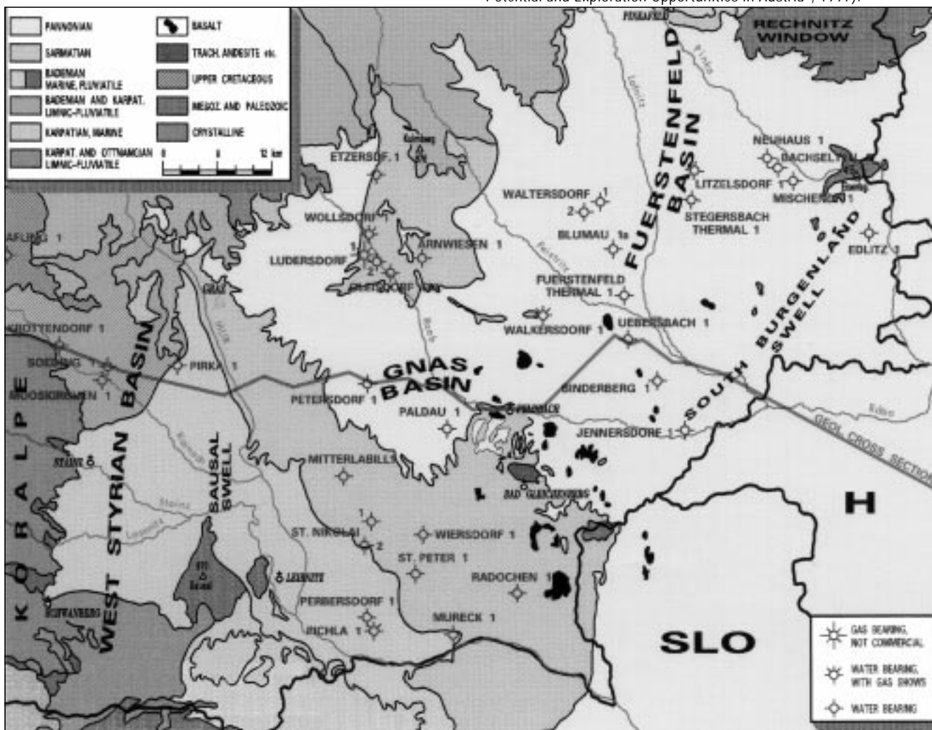
Abb. 45. Geologische Karte des Steirischen Beckens mit Lokation der Bohrpunkte auf KW und für geothermale Zwecke (aus „Hydrocarbon Potential and Exploration Opportunities in Austria“, 1997).
