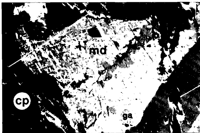
Abb. 14. Orientierte Entmischung von balkenförmigem \beta -Matildit aus Galenit. Galenit ist mit Chalkopyrit verwachsen. Brettseebaue. + Nicols, lange Bildkante 0,54 mm.
