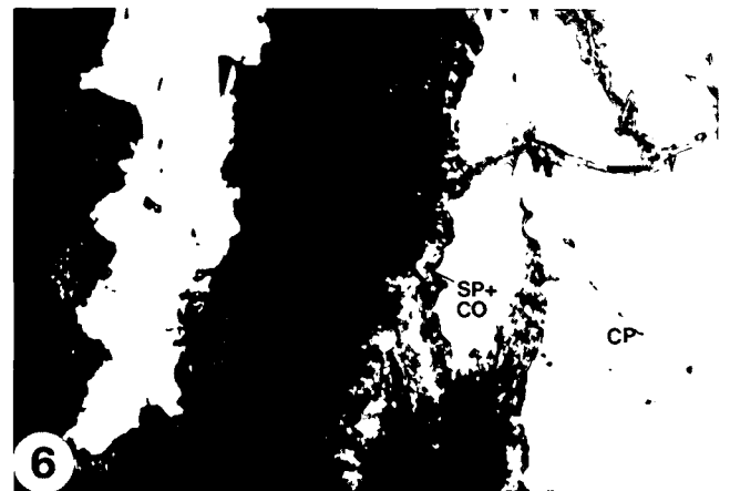
Abb. 6. Angewitterter Chalkopyrit mit schmalen Säumen von Covellin bzw. solchen von Spionkopit + Covellin. Bildbreite = 0,5 mm.
