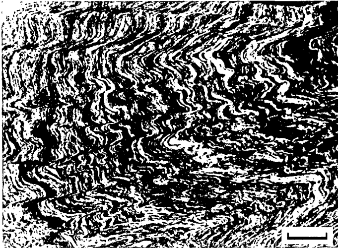
Abb. 6: Biotit-Plagioklas-Gneis der Amphibolitserie. Lok. „D“-Stollen (2180 m). Maßstab 1 cm. Anschliff. Das feingebänderte Glimmer- und Plagioklas-Gefüge zeigt eine intensive Feinfältelung mit Übergängen zwischen Biege- und Scherfaltung.
