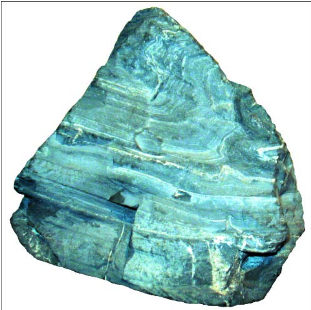
Abb. 5. Die feinlamierten Schichten der Seefeld-Subformation dienen als Ausgangsprodukt für die Herstellung des „Ichthyols“ (vulgo „Tirschenöl“). © Thomas HOFMANN.
