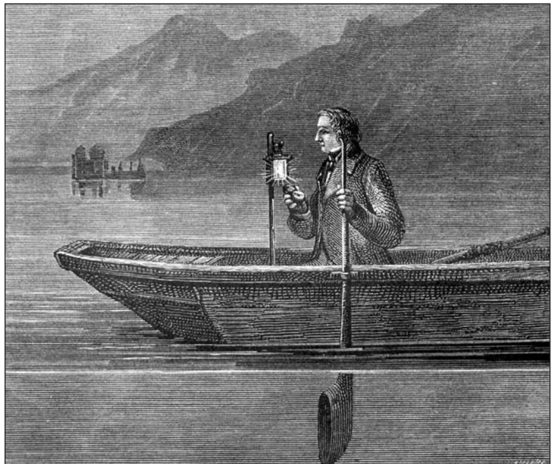
Abb. 53. Messung der Schallgeschwindigkeit im Wasser des Genfersees durch COLLADON und STURM im Jahre 1828 (Beobachtungsstation 2). Nach GUILLEMIN (1868).
