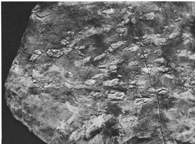
Abb. 2: Helle Kalzitkristalle im Stadium der Auflösung. Es handelt sich um Echinodermaten-Einkristalle, die mit dem Nebengestein von einer Metamorphose überprägt wurden. Bildausschnitt 18 cm; Fundpunkt 20–27.
