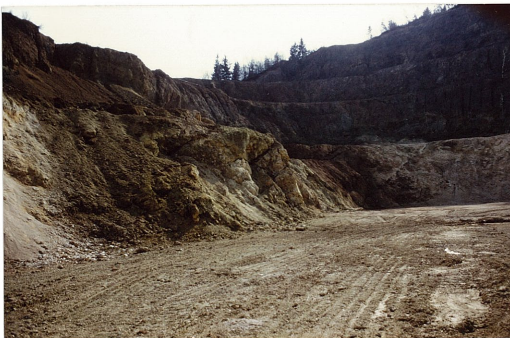
Abb. 7: Nach Osten fallende tektonische Trennflächen im Steinbruch Gossendorf.
