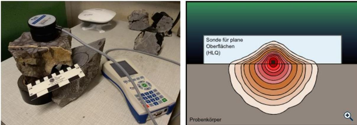
Abbildung 30: Oben: Laborergebnisse aus der Untersuchung von Aufschlussproben im trockenen und wassergesättigten Zustand zur Bestimmung der Wärmeleitfähigkeit am Geoforschungszentrum Potsdam. Unten links: Messanordnung mit dem ISOMET 2114 an der Geologischen Bundesanstalt. Rechts: schematisches Messprinzip der Halbraumlinienquelle ([www.te-ka.de](http://www.te-ka.de))<sup>16</sup>
