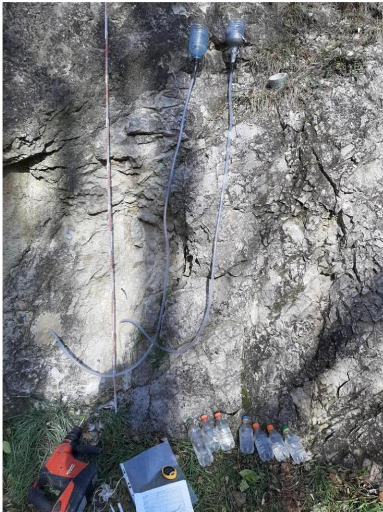
Abbildung 29: Permeabilitätsmessungen mittels Open-End-Test im Aufschluss
