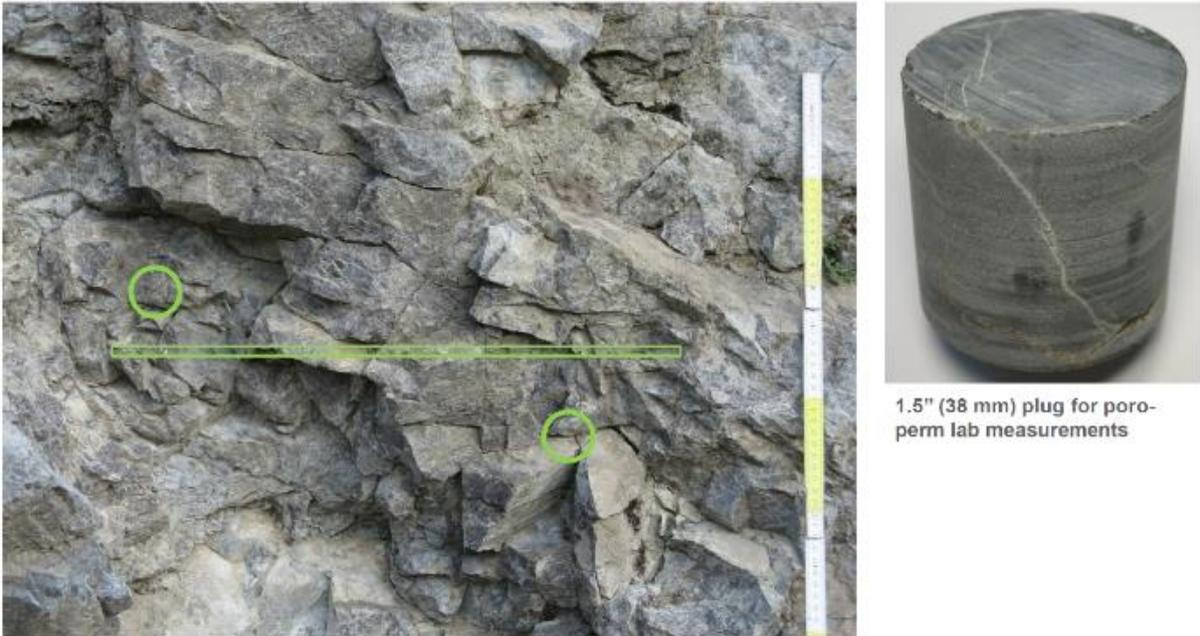
Abbildung 28: Links: Probennahme für Labormessungen und Kluftdichtemessung an einem Äquivalentaufschluss, Rechts: Probenplug für die Porositätsbestimmung im Labor mittels Permeameter
