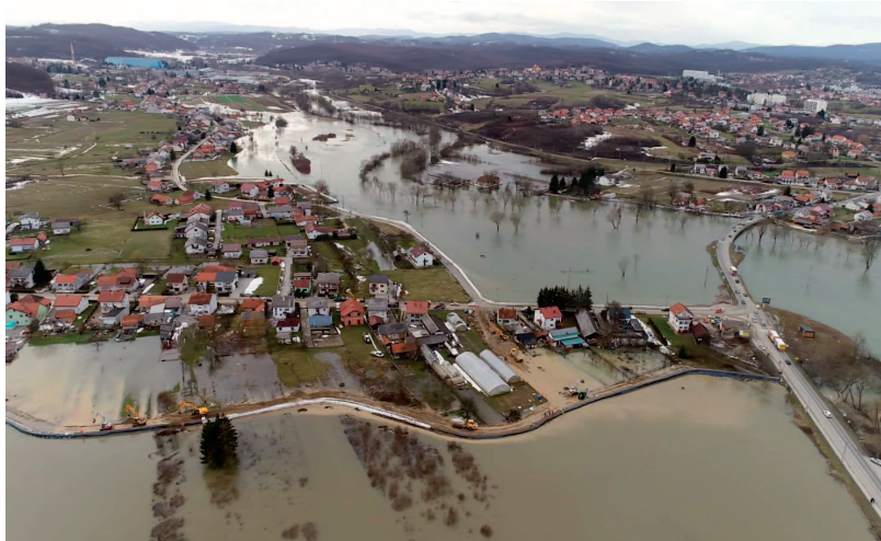
Slika 2. Karlovac Logorište, ožujak 2018. godine - postavljeni privremeni sustav box barijera štiti prigradsko naselje Logorište od izlivanja poplavnih voda Korane i Mrežnice
