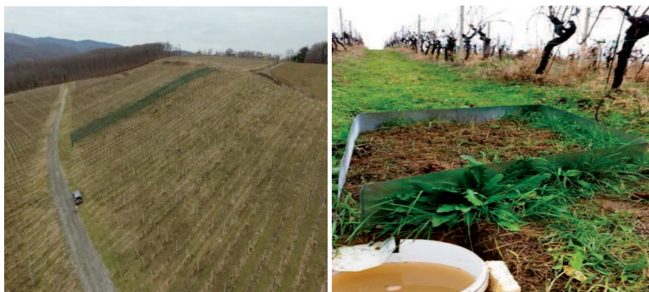
Slika 1. Prikaz nasada vinograda na lokaciji Jazbina (lijevo) i postavljenog sakupljača površinskog otjecanja u međurednom prostoru neposredno prije uzorkovanja (desno)
