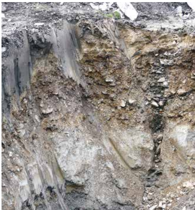
Fig. 19 - Orizzonte limoso osservato in uno scavo temporaneo eseguito in posizione di fondovalle in località San Giacomo. - Mud horizon with thinner lenticular interbedded gravels. - Temporary dig along the valley bottom at San Giacomo village.
