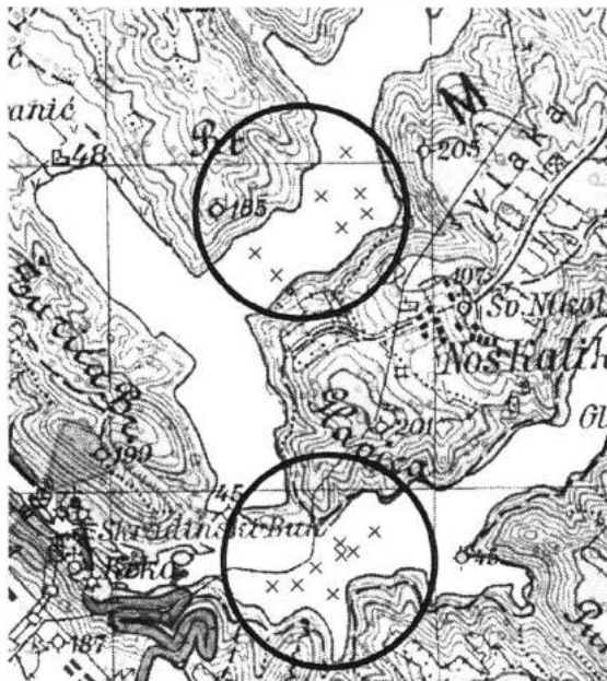
Slika 1. Lokacije postavljanja strujomjera u Visovačkom jezeru i Čikoli
