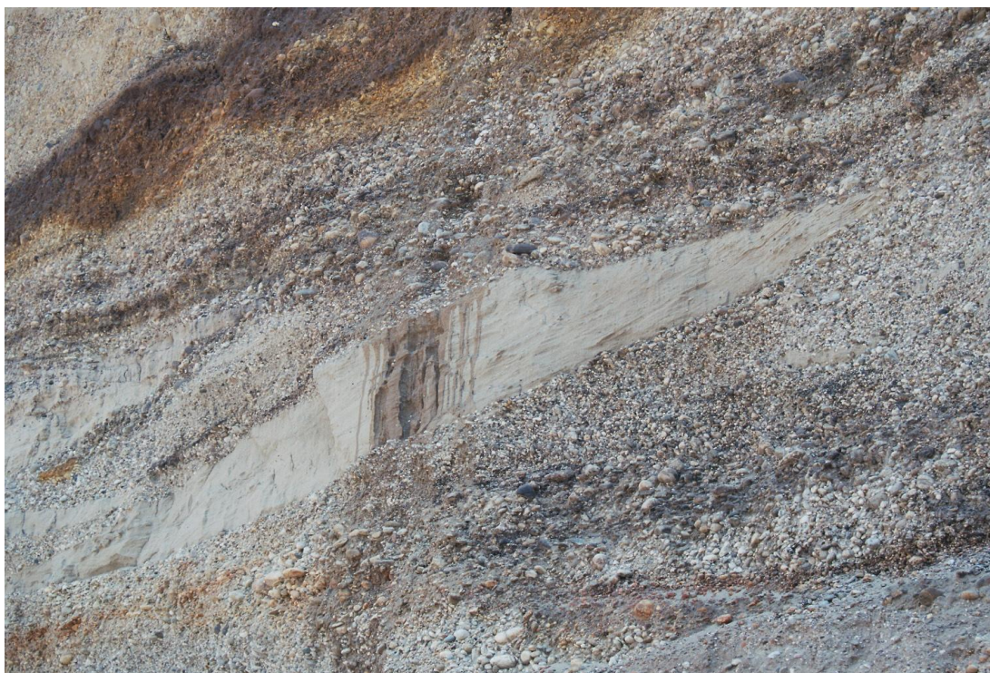
Kiesgrube Obersiebenbrunn, Wechsellagerung von Flusssedimenten unterschiedlicher Korngrößen – typisches Beispiel für den Aufbau eines Porengrundwasserleiters (z.B. Marchfeld), © R. Philippitsch, BMLFUW.
