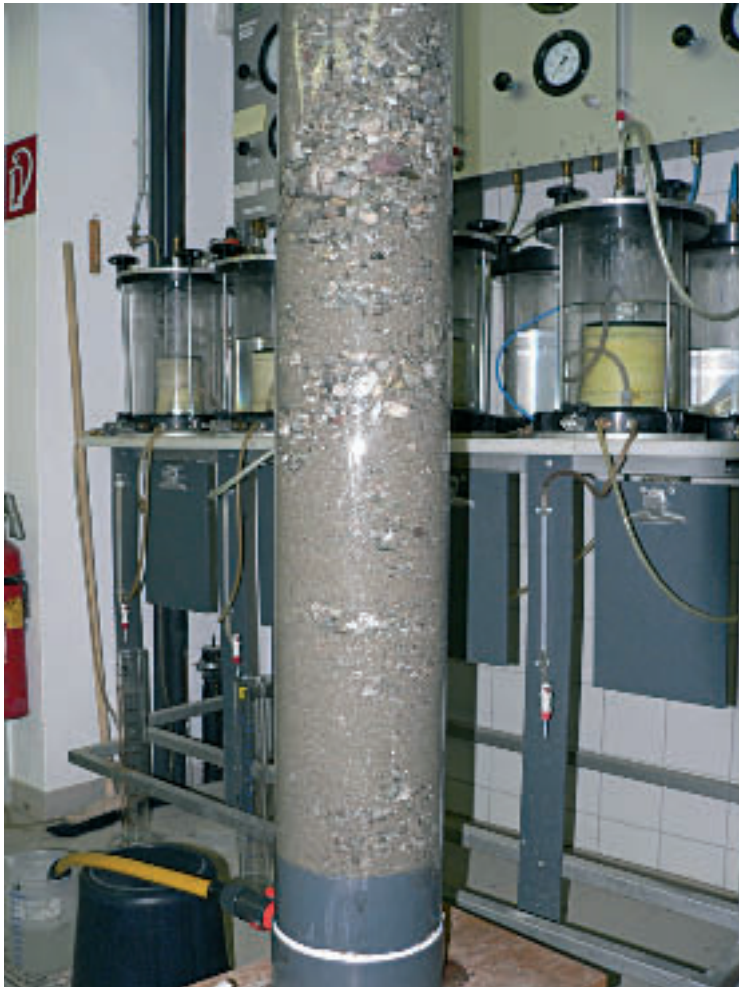
Abb. A/2-1: Kieskolben-Versuch 2005, Versuch im Labor Geotechnik (Arsenal) zur Beurteilung der Wassergehalte bzw. der Verweilzeiten von Sickerwasser in ungesättigten Kieskörpern (Quarzsotter, fast karbonatfrei aus Kiesgrube Schernham bei Haag a.H.), © Spendlingwimmer.
