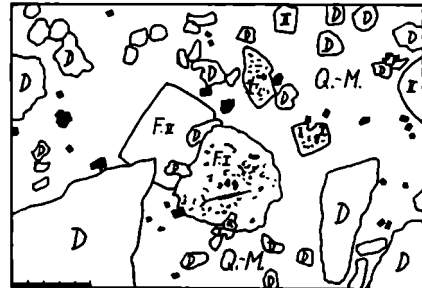
Abb. 5: Früh- (F I) und Spätkristallisation (F II) von Fluorit in Hohlraumbrekzie. 40 fach, Balkenlänge = 0,5 mm. Q.-M. = Quarz-Matrix; D = Dolomit; schwarz = Pyritkristalle (Würfel und Pentagondodekaeder). Zeichnung nach einem Dünnschliff-foto.
