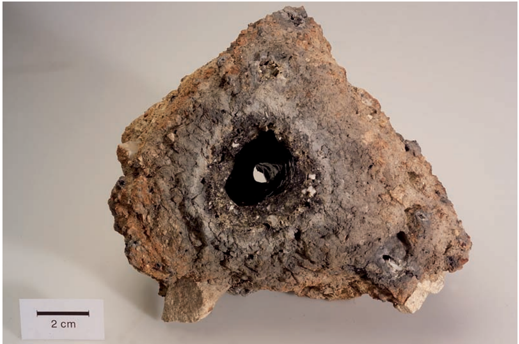
Abb. 4: „Fulgurit“ von Kaltenbach, Gemeinde Vitis. Fragment mit Schmelzröhre (Röhrenachse ungefähr senkrecht zur Bildebene). Die sich von oben (Durchmesser ca. 4 cm) nach unten (Durchmesser ca. 1,5 cm) verjüngende Röhre zeigt eine glatte Innenseite aus schwarzem Glas. An den Glaskern, der im Anbruch grauschwarz erscheint, schließt eine Sinterzone mit gefrittetem Bodensediment an. Im Übergangsbereich vom Glas zur Sinterzone hebt sich deutlich ein weißlicher Saum ab, der offensichtlich eine Reaktionszone markiert.
