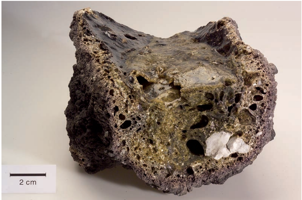
Abb. 2: „Fulgurit“ von Kaltenbach, Gemeinde Vitis. Bruchstück einer konzentrisch aufgebauten Schmelzrinne bestehend aus einem gelbgrünen Glaskern mit cm-großen Blasen Hohlräumen und einer von schwarzem Glas dominierten Oberseite. Der Kern geht nach außen hin in aufgeschäumtes blasenreiches Glas über und wird von einer schlackenartigen Schmelz- und Sinterzone begrenzt. Ein etwa 2 cm großer Quarzeinschluss (rechts unten) ist auf der Innenseite teilweise angeschmolzen und zu blasigem Quarzglas erstarrt. An der Oberfläche der Schmelzrinne ist der Glaskörper hochglänzend und zeigt Fließstrukturen mit ineinander übergehenden Partien von schwarzem und gelbgrünem Glas.
