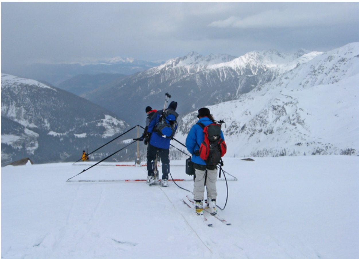
Abb. 2: Georadar-Messungen am Blockgletscher Rossbänk im Ultental.
