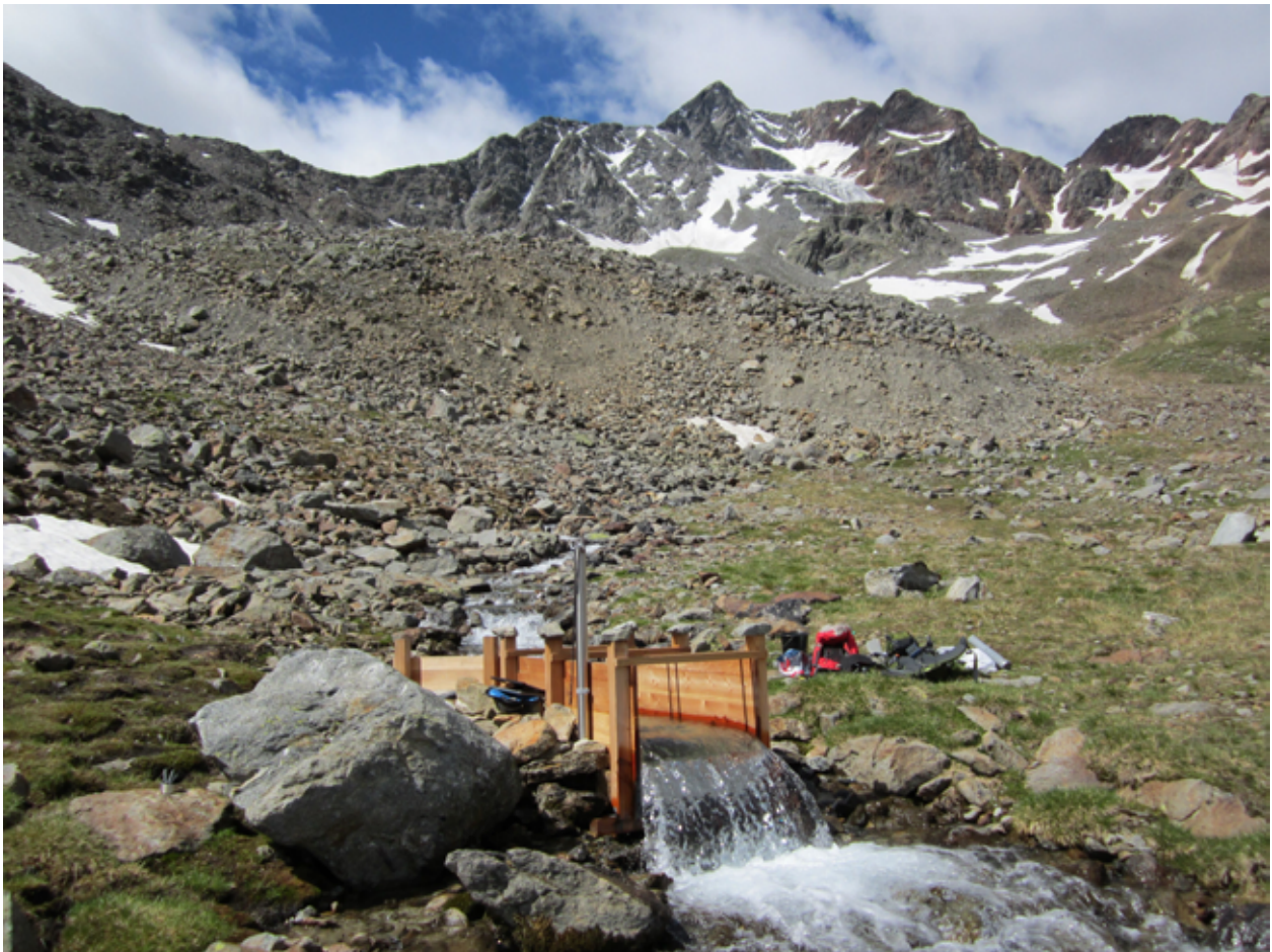
Abb. 3: Pegelmessstelle am Abfluss des Blockgletschers Lazaun, dessen Stirn im Hintergrund zu sehen ist.
