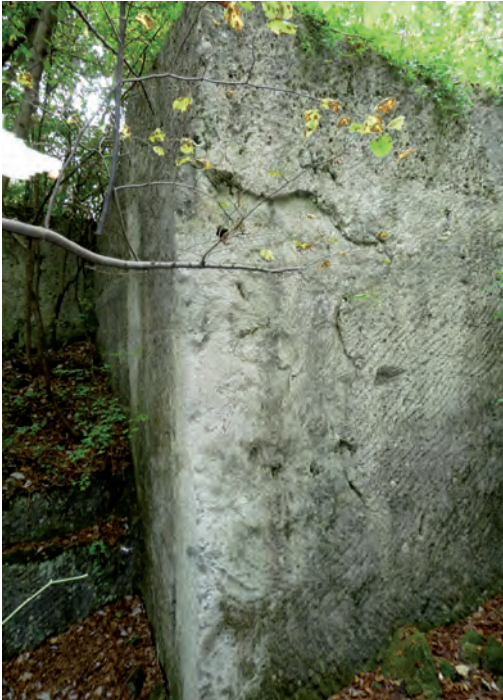
Abb. 62. Steinbruch „Kürschnergrube“ mit schrägen Schrämmspuren im Leithakalk des Badeniums (38).
