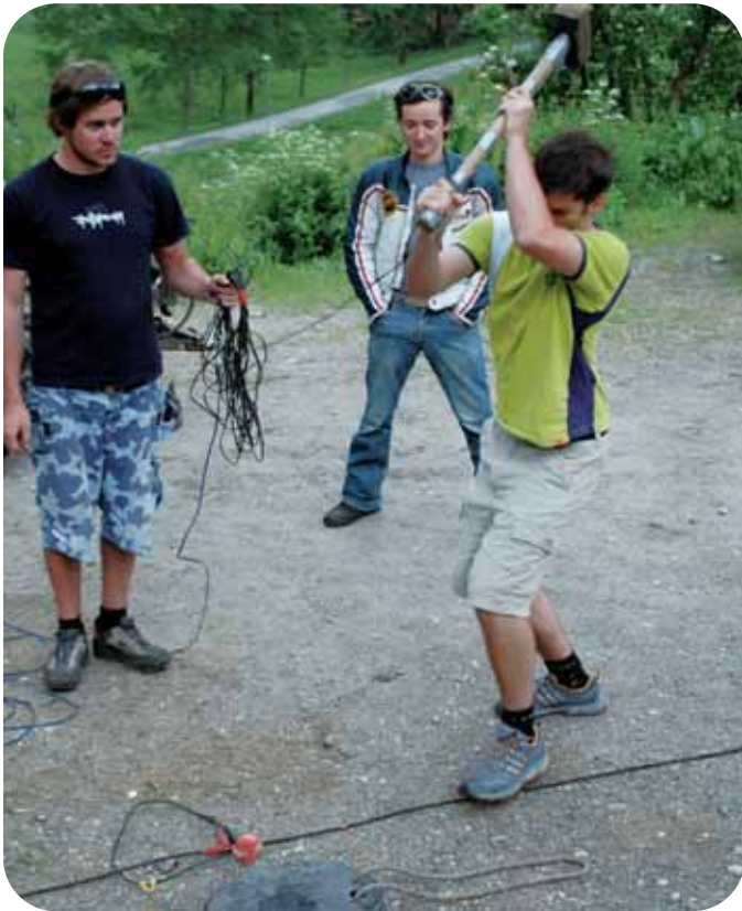
DIE STUDENTEN ÜBEN SICH IN HAMMERSCHLAGESEISMIK Erkundung des Untergrundes im Bereich 1. Wiener Hochquellenwasserleitung.
