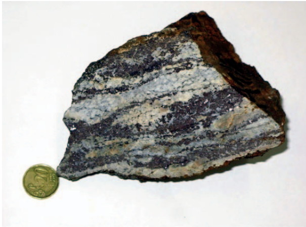
Abb. 3: Typisches Erscheinungsbild von Sphalerit und Galenit der Lagerstätte Pflersch-Schneeberg. Die Erze sind schieferungskonkordant in das Nebengestein eingelagert.
