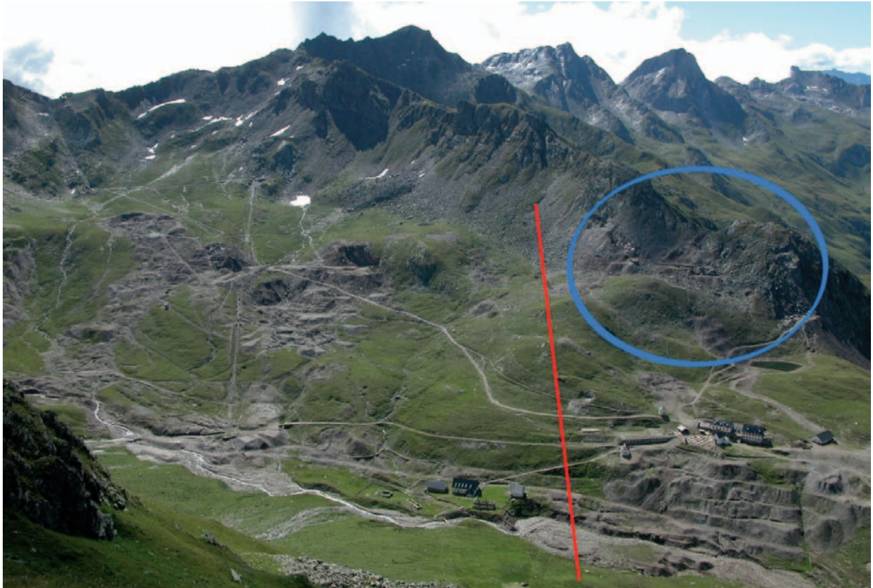
Abb. 23: Der Schneeberg aufgenommen von der im N gelegenen Schneeberger Weißen. In rot wurde die ungefähre Lage der Martinskluft und in blau der Bereich eingefärbt, der die Verfallung zeigt. Auffallend und zugleich charakteristisch ist, dass entlang sowie in der Nähe der Martinskluft keine Stolleneingänge zu finden sind.
