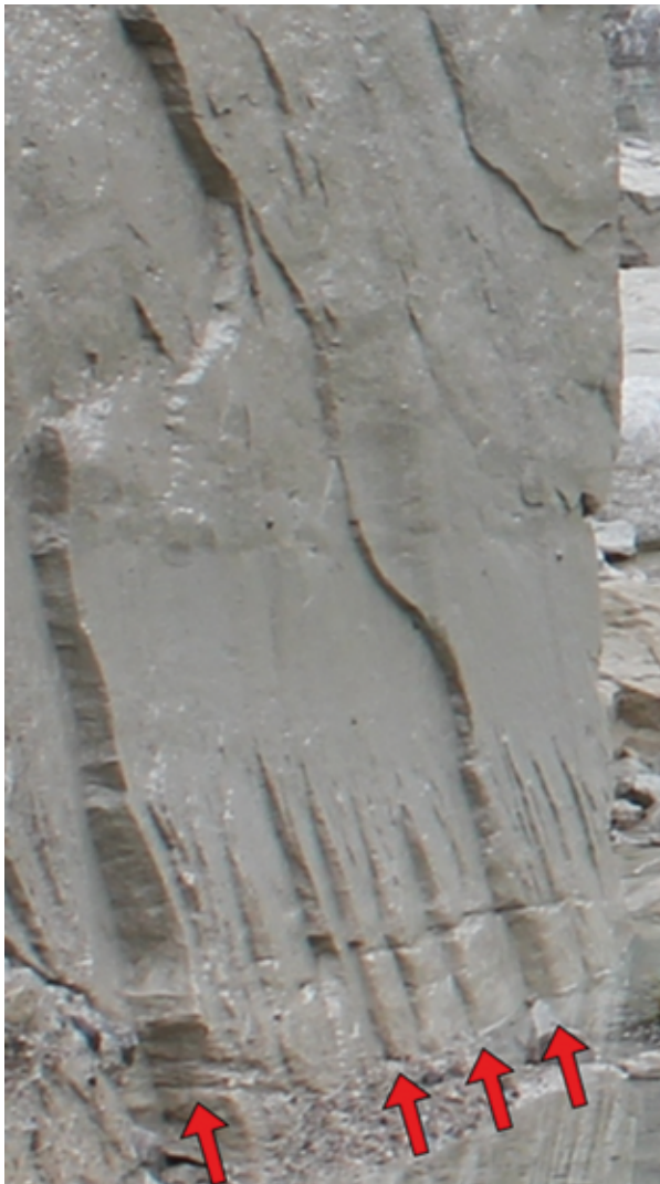
Abb. 14: Randklüfte auf der Aufschlußoberfläche (?K5) am Südrand von Aufschluss 2. Die Randklüfte zeigen, dass die Kieslage am unteren Rand des Bildes den Diamikt darüber mechanisch entkoppelt und als freie Oberfläche wirkt.
