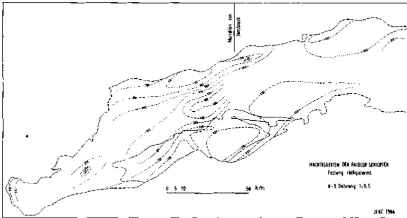
Abb. 2: Gesamtmächtigkeiten der Raibler Schichten. Faltung rückgeformt (Nord-Süd-Dehnung 1 : 1,5).
