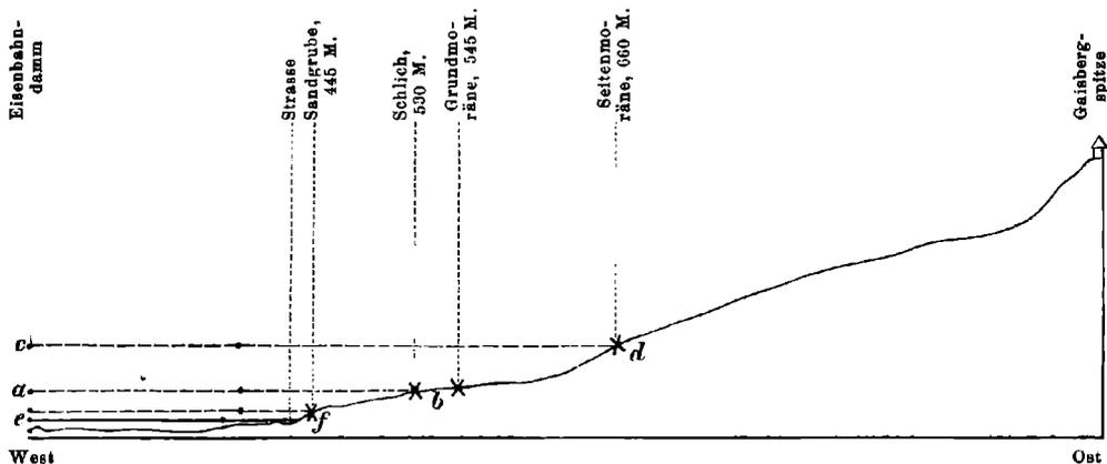
Die Moränen zwischen 530 und 660 M. gehören der älteren, jene am Fusse des Berges der jüngeren Eiszeit an. Die Linie *ab*, 530 M. ü. M., bildet die Basis oder Thalsohle, die Linie *cd*, 660 M., das Niveau des Gletschers während der älteren Eiszeit, *ef* die Basis
