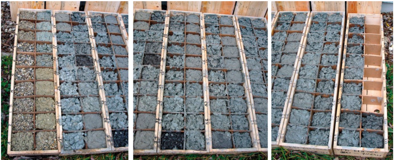
Abb. 19. Bohrgut der Spülbohrung Kittsee 0–112 m. Deutlich sichtbar die bräunlichen hangenden Terrassensedimente sowie in der pannonen stahlgrauen Abfolge die schwarzen Kohleeinschlusungen bei 36 und 40 m.
