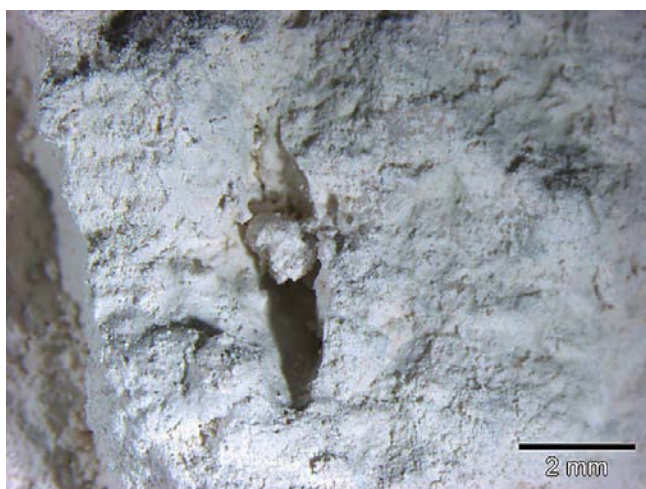
Abb. 30. Leithakalk, schluffig-krümelig, Probe aus 42,5 m Teufe (Nr. 091203-089).
