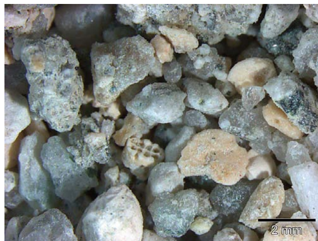
Abb. 31. Schotter der Rust-Formation, kiesiger Sand, siliziklastisch, Probe aus 63 m Teufe (Nr. 091203-090).
