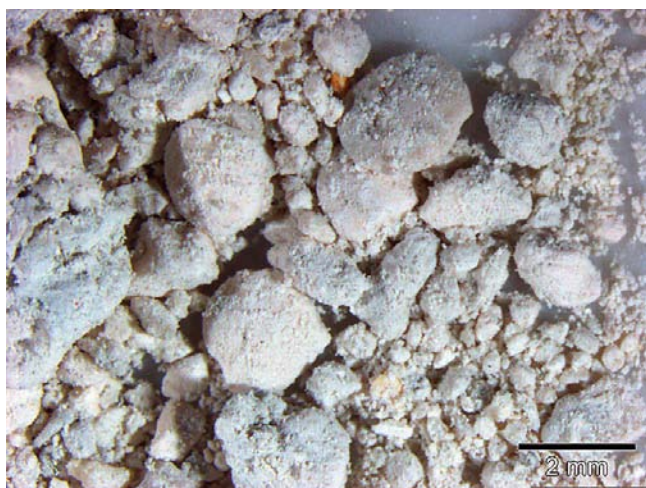
Abb. 29. Leithakalk, Probe aus 40 m Teufe (Nr. 091203-088).
