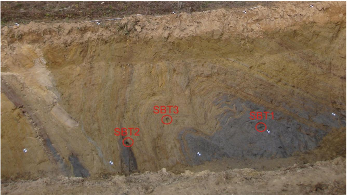
Abb. 4. Aushub an der Nordseite der Sandgrube Steinbrunn, liegendste Einheit A1 mit Verfaltung, Mächtigkeit ca. 6 m. Probenpunkte rot markiert.
