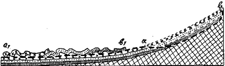
Fig. 9. Die Gleitmasse  $a-b$  zerteilt sich beim Abgleiten in drei Teilgleitmassen, welche nun die breitere Lagerstätte  $a_1-b_1$  beanspruchen.
