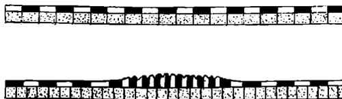
Die Überschiebung der ersten Art bedeutet ein Gleiten der oberen über die unteren Schichten, wobei es beiderseits zu Faltungen kommen kann oder nicht.
