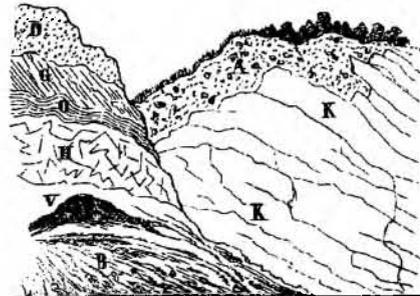
D Dammerde. — G Aufgelöster Gneiss. — O Grüner Opal. — H Brauner Hornstein. — V Vertiefung. — B Abschüssiger Boden des Bruches mit Schutt. — A Dammerde mit Steinstücken. — K Körniger Kalkstein.
