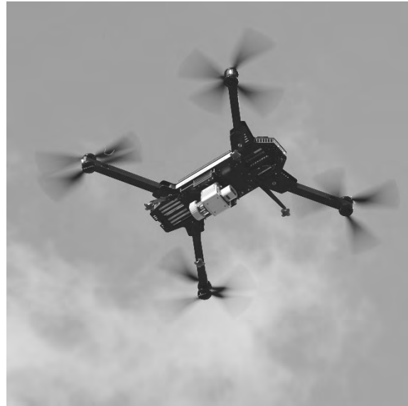
RICOPTER mit VUX-SYS für die UAV-basierte Scan- und Bilddatenaufnahme, ideal in schwer oder nicht zugänglichen Umgebungen
