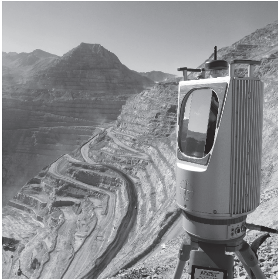
RIEGL VZ-4000 3D Laserscanner, ideal für den Einsatz im Tagebau
