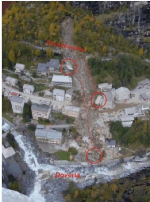
Position der 3 durch die Hangmure weggerissenen Mauerelemente :
