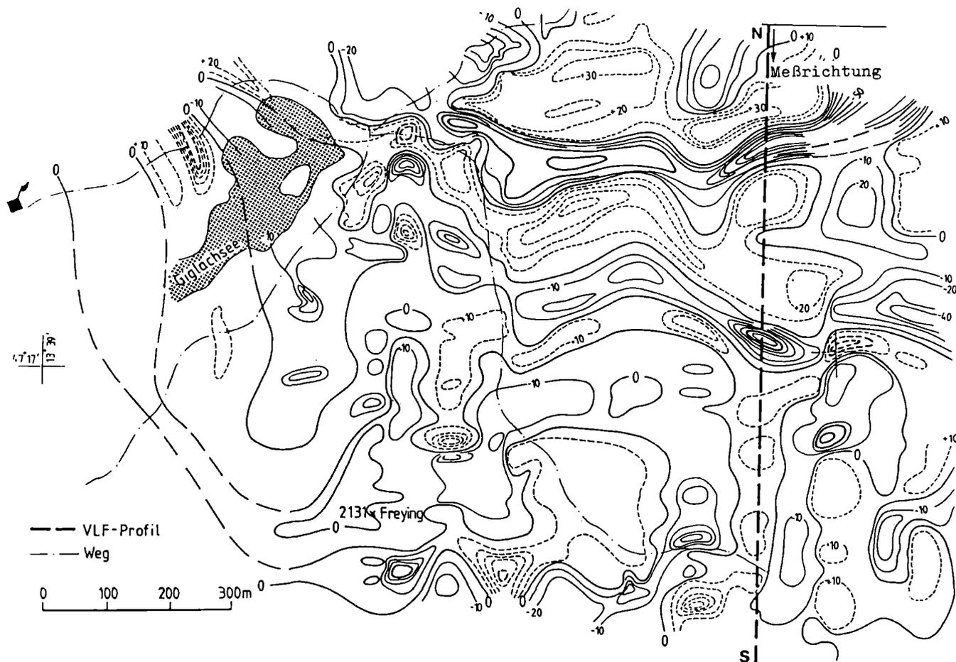
Abb. 16/5: Frasergefilterte Realkomponente der VLF-Elektromagnetik im Gebiet Giglachsee-Vetterkar.
