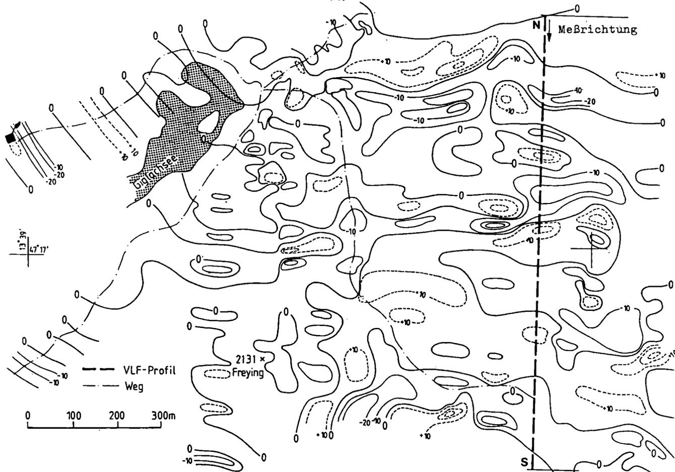
Abb. 16/6: Frasergefilterte Imaginärkomponente der VLF-Elektromagnetik im Gebiet Giglachsee-Vetterkar.
