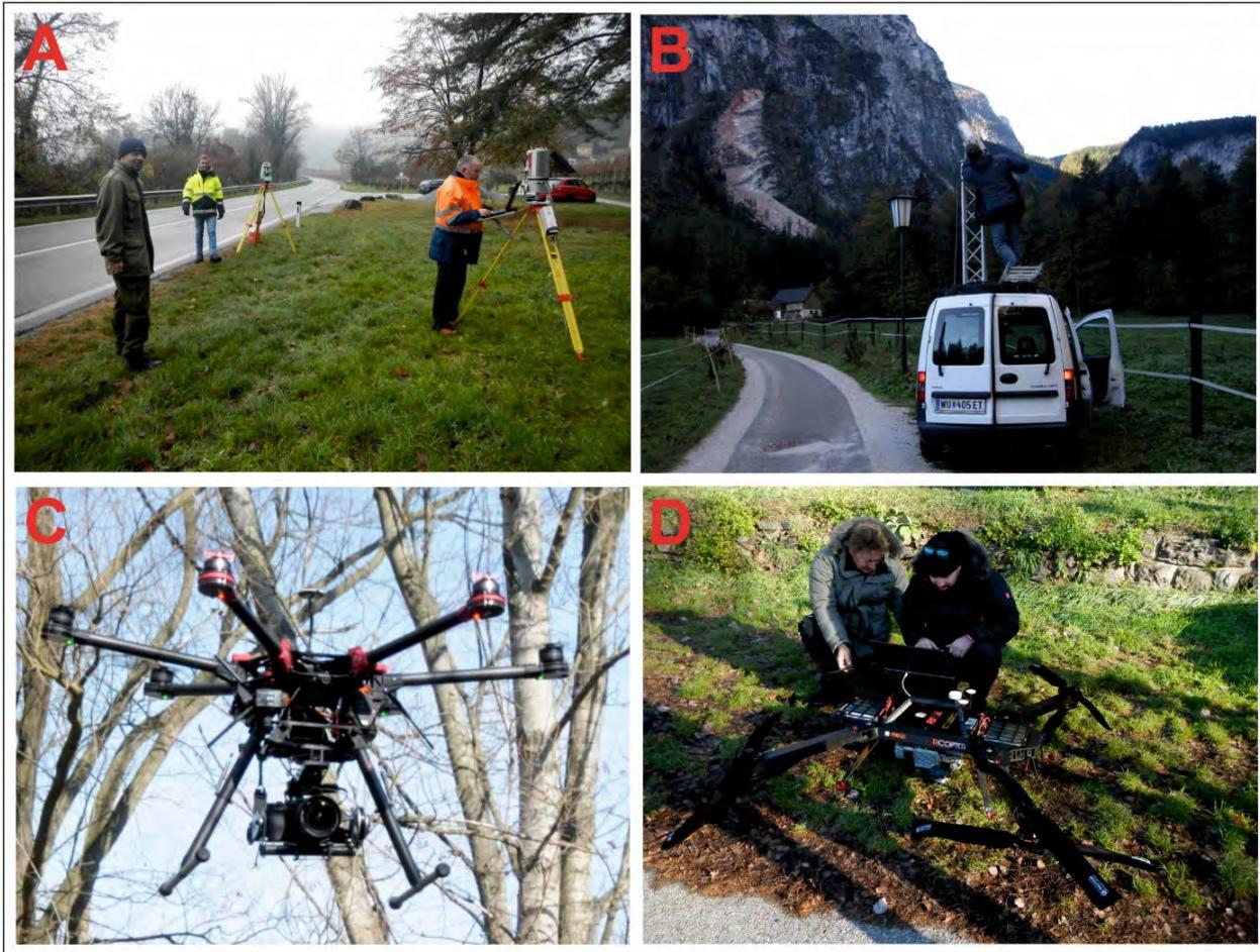
Abb. 1: Übersicht unterschiedlicher Datenerhebungsmethoden. (A) stop-and-go, TLS-Vermessung mit einem Stativ; (B) stop-and-go, TLS-Vermessung mit einem Fahrzeug (MELZNER et al., 2013; SCHILLER & MELZNER, 2017); (C) Hochauflösende photogrammetrische Vermessung unter Verwendung eines ShapeMetriX-UAV (Kamera Sony A7R, Foto: Andreas Gaich); (D) Mobile TLS-Vermessung mit einem RiCOPTER, der mit einem Laserscanner VUX-SYS AP20 ausgestattet ist (Quelle: MELZNER & SCHWARZ, 2019).
