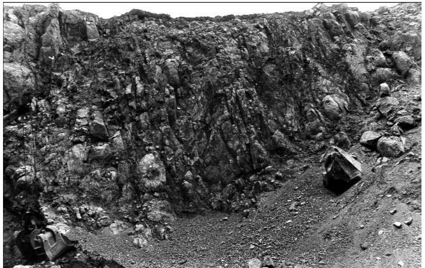
Abb. 16. Vorwiegend waagrechter Wechsel von Hartbasalt und Sonnenbrenner. Basaltsteinbruch Pauliberg; Abbaustadium 1971, oberste Etage.
