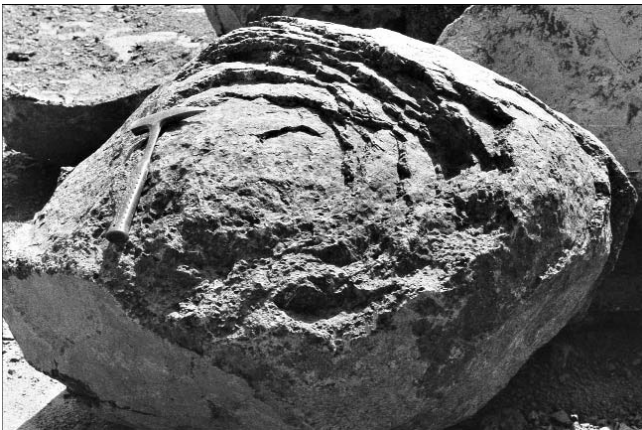
Abb. 5. Nicht beständige Basaltkugeln aus Sonnenbrennerbasalt. Der nur z.T. zugerundete Kluffkörper schält weiter ab und zerfällt zuletzt in Graupen.
