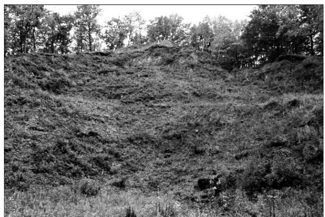
Abb. 47. Tuffit-Steinbruch Steinberg bei Grieselstein. Wenig verfestigter Tuffit. Sehr rasch verwitterndes Gestein mit schlechten bautechnischen Eigenschaften und niedriger Standfestigkeit der Steinbruchwände. Die rasche Renaturierung allein lässt schon auf einen hohen Tonmineralgehalt der Tuffite schließen.
