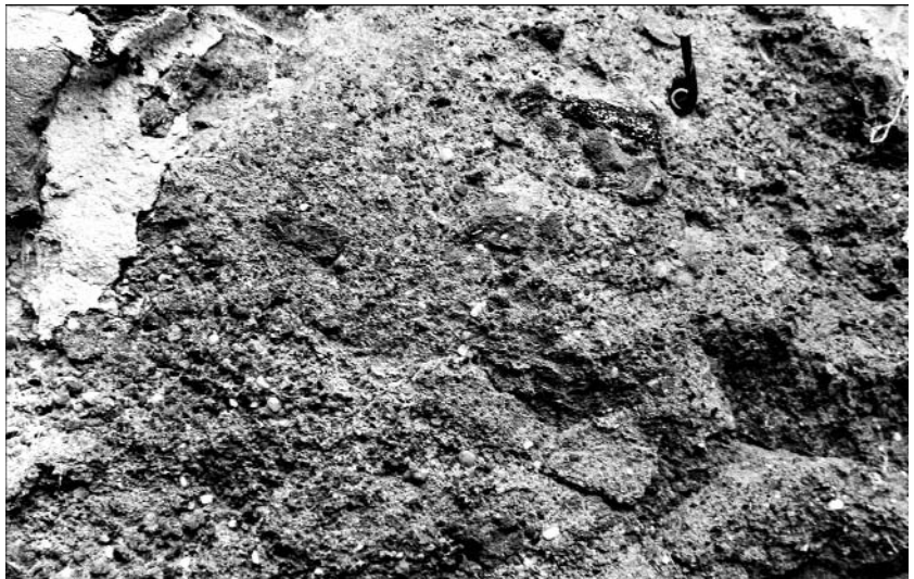
Abb. 40. Baustein der Burg Güssing. Basalt-Tuff mit z.T. groben, z.T. feinen Basaltbruch- stücken neben Sand und kleinen Kiesen. Sehr gut verkittet und daher sehr fest und verwitterungs- beständig.
