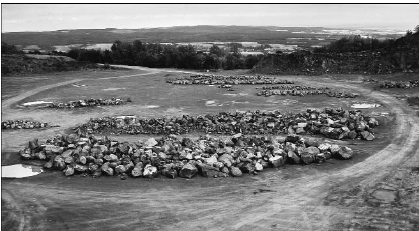
Abb. 22. Blick gegen NW: Große Kluftkörper und „Basaltkugeln“. Basaltsteinbruch Pauliberg: Abbaustadium 2001 (untere Etage).
