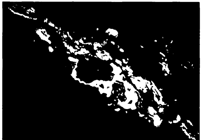
Abb. 6: Eine der Goldfeinlagen in Feinquarzit im Innsbrucker Quarzphyllit. Ged. Gold (weiß, z. T. in s gelängt) mit etwas Arsenkies und Pyrit (weißgrau), Quarzit (grauschwarz), Ankerit (grau bis dunkelgrau). Polierter Anschliff, Nicols ||. Natürliche Größe des Bildausschnittes: 1,28 x 0,84 mm. Lagerstätte Zell am Ziller.
