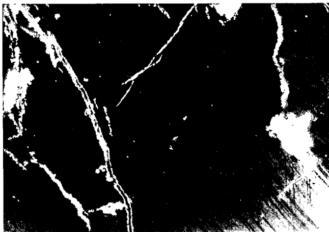
Abb. 3: Polysynthetische, feinlamellare Zwillingsbildung in einem Kupferkieskorn, tektonisch verbogen. Entlang von Rissen sind Covellin (weiß) und Limonit (grau bis weiß) ausgeschieden. Polierter Anschlag vom Rauhen Kopf, Nicols +.
